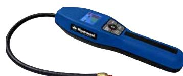
Detecta fugas de hasta 1,5 gramos /año, válido para gases combustibles, hidrógeno y refrigerantes como CFC's, HCFC's y HFC's. Alimentación dos baterías tipo D.
